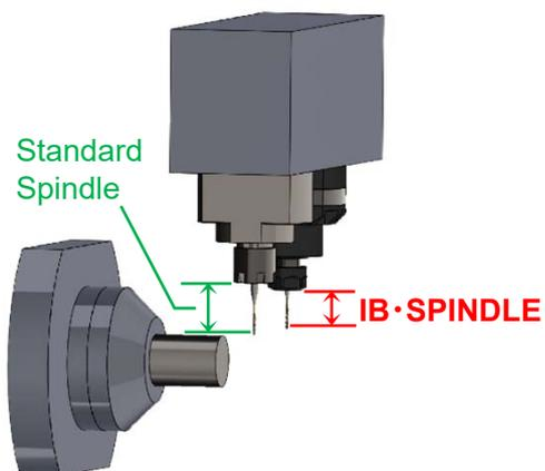
■標準回転工具と比べて20mm 程長く設計されている為、刃物の突出し量を少なく加工をする事が可能。
